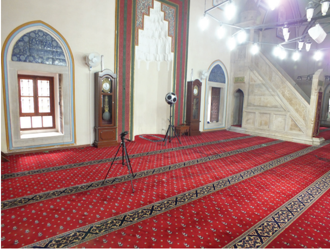
Fot 10: Ölçüm düzeneği - Alıcı ve kaynak noktası yerleşimi
