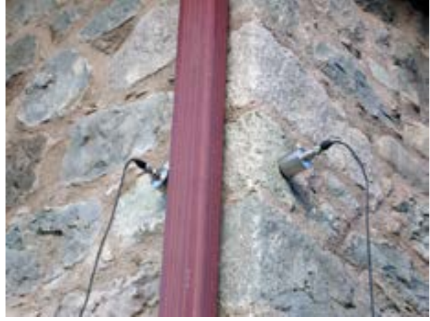
Fotoğraf 6. Sundura Camisindeki ölçümde ivmeölçer yerleşimine ait görüntüler.
