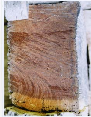
Resim:22 Dendrokronoloji yöntemi ile 1204, 1205 ve 1211 yıllarının belirlendiği ağaç kesiti.
